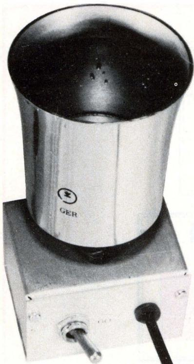
La lavatrice che vi presentiamo, non ha certo le possibilità dei modelli industriali che assorbono numerosi kilowatt dalla rete ed impiegano grosse valvole trasmettenti negli oscillatori. Funziona però sull'identico principio di quelle macchine ed è assai utile per la pulizia di minuscoli congegni appartenenti a strumenti ottici o meccanici di precisione.
