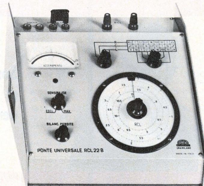
Il Ponte RCL 22 B riunisce in un unico complesso di dimensioni limitate, sia i comandi del ponte propriamente detti, adatti per misure di resistenze, capacità e induttanze, sia le varie parti ad essi asservite e cioè: un generatore di tensione continua, un generatore di tensione a 1000 Hz, un galvanometro indicatore di zero ed un amplificatore se
